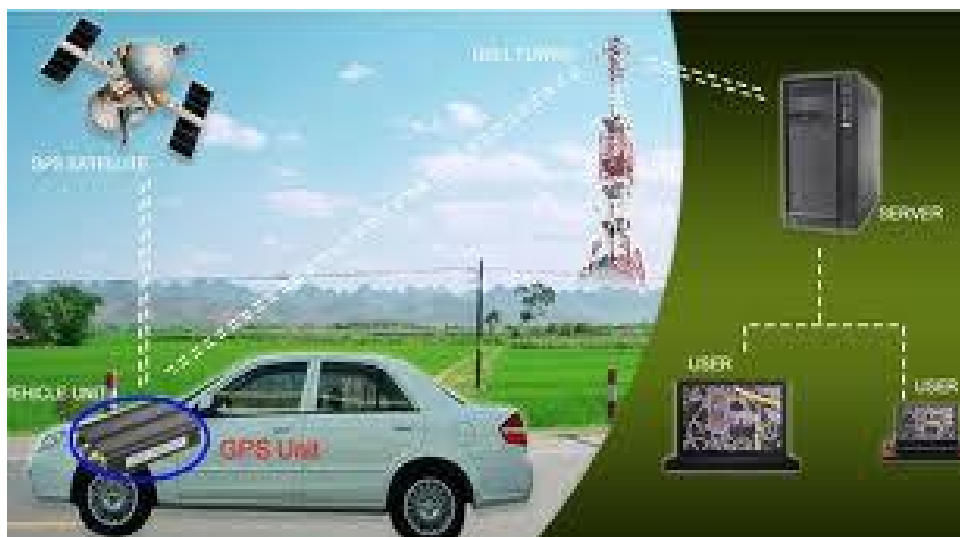
Gambar 3. Contoh cara kerja GPS Tracking sistem
